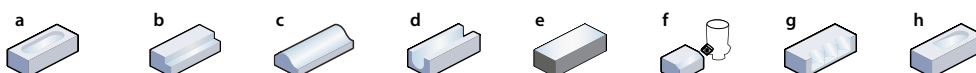
a Frezowanie rowków wpustowych b Frezowanie naroży c Frezowanie kształtowe d Frezowanie rowków e Frezowanie czołowe f Frezowanie faz g Frezowanie z posuwem wglębnym h Interpolacja śrubowa/zagłębianie skośne
