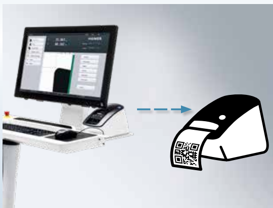
Nach dem Messen des Werkzeuges wird ein Etikett mit QR-Code gedruckt After measuring the tool, a label with the QR code is printed
