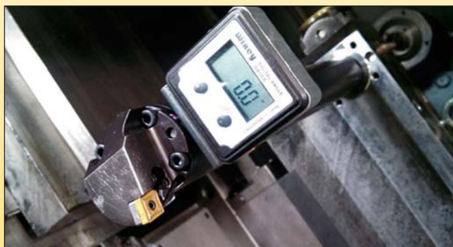
Rysunek 4: Regulacja wytaczaka
