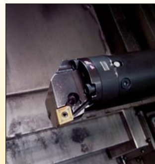
Rysunek 3: Spłaszczenia kołnierza wytaczaka
