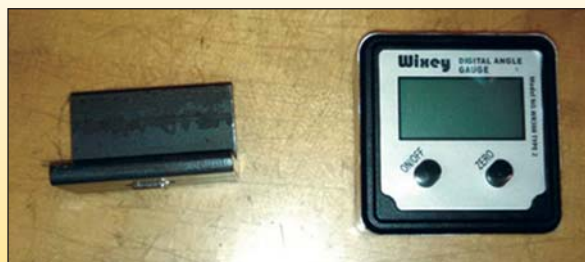
Rysunek 1: Gniazdo kątomierza cyfrowego (po lewej) i kątomierz cyfrowy (po prawej)
